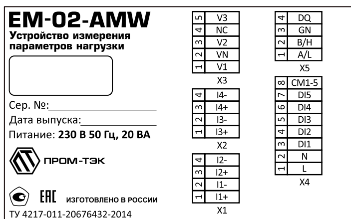
Рисунок 1.4 – Информационная наклейка устройства
